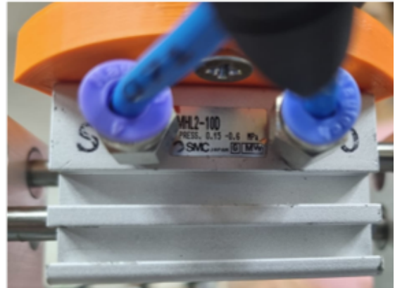
Figura 11. Atuador MHL2-10D instalado.
