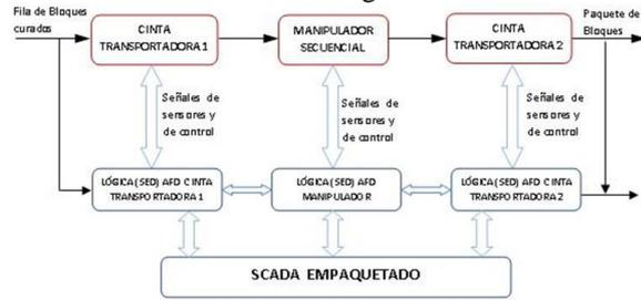
Figura 11. Subprocesos y lógica de automatización local en empaquetado de bloques de construcción.
