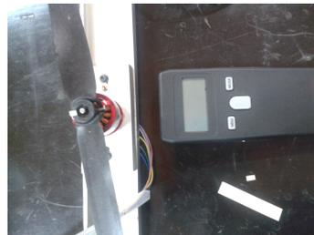
Figura 45 – Tacômetro utilizado para leitura da rotação.
