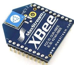
Figura 9 – Módulo Xbee
