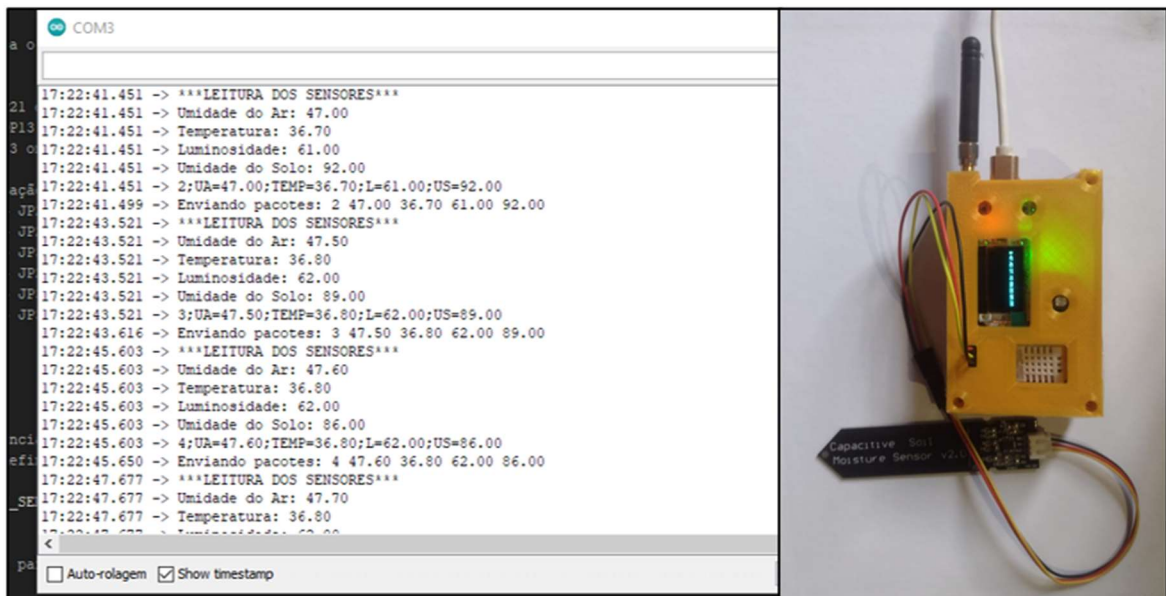
Figura 40 - Teste de funcionamento dos sensores com o microcontrolador
