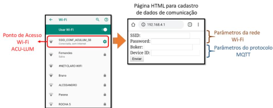
Essa rotina de cadastro faz com que o microcontrolador forneça um ponto de acesso local possibilitando qualquer o acesso de qualquer dispositivo. Ao realizar uma conexão através de um computador ou *smartphone*, por exemplo, o usuário pode informar dados de cadastro como para o dispositivo operar em rede.
