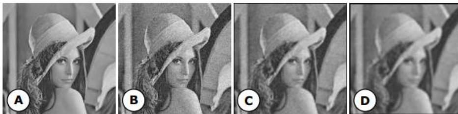
Figura 8: Aplicação do filtro de média: (a) imagem original; (b) imagem com ruídos atenuados; (c) imagem filtrada com uma máscara 3x3 e (d) imagem filtrada com uma máscara 5x5 (Queiroz & Gomes, 2001).
