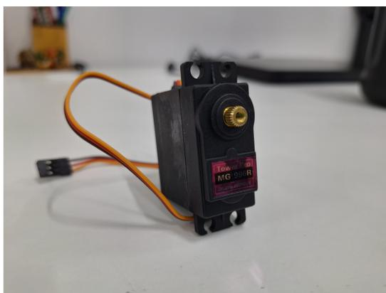
Esse servomotor toma como entrada pulsos de PWM de forma a controlar o ângulo do seu eixo. Sua alimentação é de 5V a 12V e seu eixo gira em uma angulação de até 180°. Por possuir uma malha interna para o controle de posição que garante que o ângulo de
