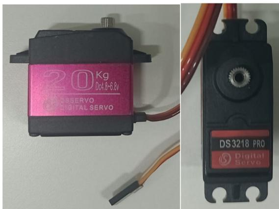
Este servomotor opera ao receber pulsos de modulação de largura de pulso (*PWM*, do inglês *Pulse-Width Modulation*), utilizados para controlar o ângulo de seu eixo. A faixa padrão de amplitude de tensão abrange até 3,3 V ou 5 V. O suprimento de energia situa-se entre 4,8 V e 6,8 V, permitindo que o eixo realize rotações de até 180°.
