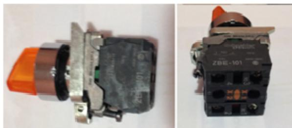
Figura 31 – Chave seletora utilizada no protótipo.
