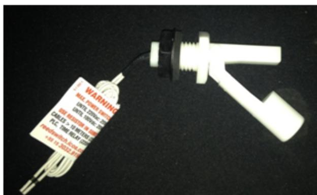
Figura 51 – Sensor de nível tipo bóia magnética utilizado.
