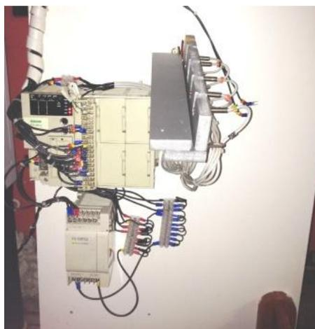
Figura 61 – Subsistema de identificação de moedas montado na placa da interface.
