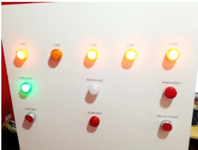
Figura 62 – Exibição do teste do funcionamento da interface integrada a identificação de moedas indicando nos *led's* acionados na sequência 1, 5, 10 e 20 litros.
