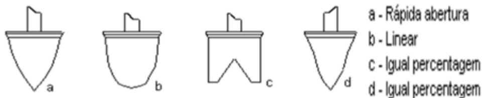
Figura 5 – Tipos de cunhas relacionadas com as características de uma válvula de controle.
