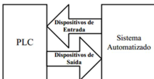
Figura 7 – Aplicação geral de um controlador lógico programável.
