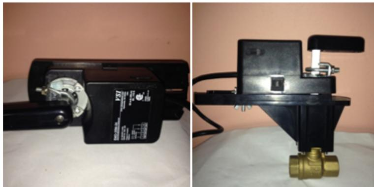
Figura 50 – Válvula de controle proporcional utilizada.
