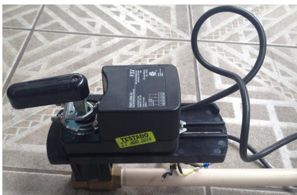
Figura 6 – Válvula controle proporcional VSI® EMO-35M-24.
