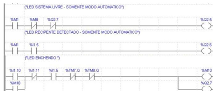
Figura 41 – Captura da tela da programação dos *led*'s: disponível, detecção de recipiente e enchendo.
