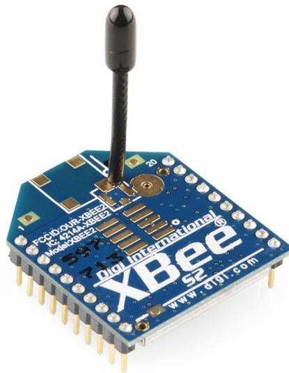
Figura 37 – Módulo XBee®
