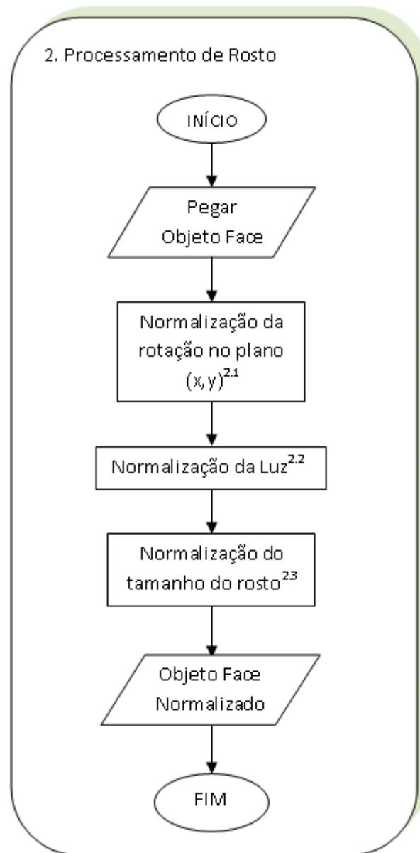
Figura 23 – Fluxograma 2 - Processamento do Rosto.
