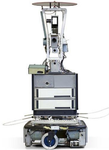
Figura 1 – Shakey, o primeiro robô móvel no ano de 1968.
