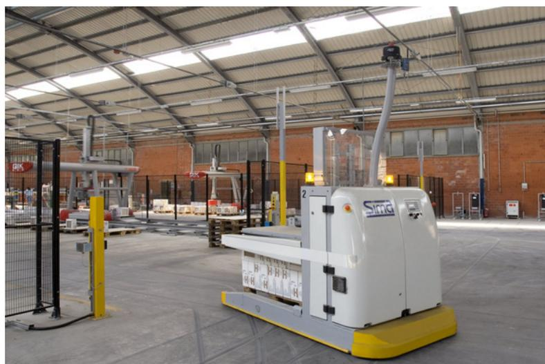
Figura 7 – Exemplo de um robô móvel do tipo LGV
